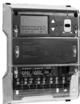
Рисунок 1 - Счетчик SM302 с установленным радиомодемом.
